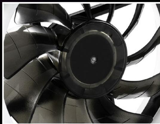
流体動圧軸受を採用した堅牢な 120 mm ファンは、毎分 1200 回転で 94.8 m<sup>3</sup>/h のエアフローを生成し、最大動作時でも 18.2 dBA を超えません。
