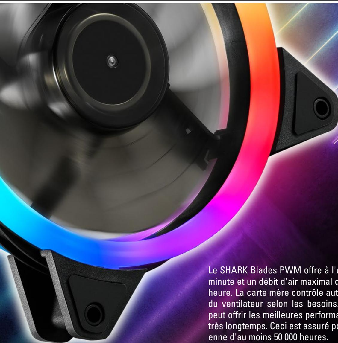
Le SHARK Blades PWM offre à l'utilisateur 1400 tours par minute et un débit d'air maximal de 94,8 mètres cubes par heure. La carte mère contrôle automatiquement la vitesse du ventilateur selon les besoins. De plus, le ventilateur peut offrir les meilleures performances possibles pendant très longtemps. Ceci est assuré par une durée de vie moyenne d'au moins 50 000 heures.
