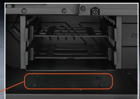
Lüftungsschlitze für die optimale Kühlung der Laufwerke
